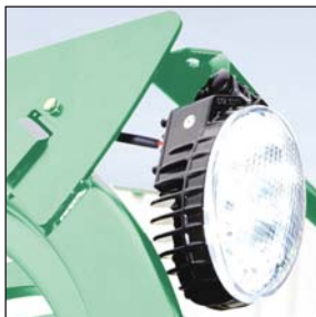
Przednie diodowe oświetlenie robocze
